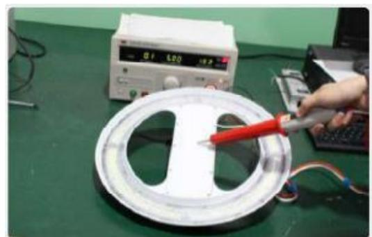
短絡・誤動作・故障などの突発的なサージにより、故障や事故の原因とならないように耐電圧が規定内にあるかどうかの試験を実施した結果、問題無し
