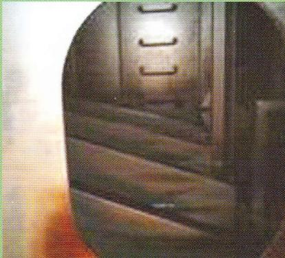
▲「2006年9月06日、FO Tank No.2P 内部状況。スラッジなし。構造物にFOの付着なし」
