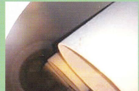
「2006年9月26日、M/E Exhaust Manifold. 燃焼良好、排気噴出し管がクリーム色です」、「LUBRICON不投入ではこの辺りの色相は一般的に灰色か黒色です」
